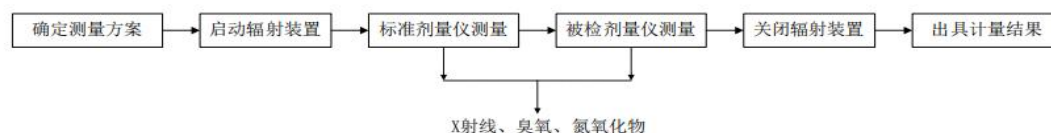
图 7 X 校准装置工艺流程及产污节点图
